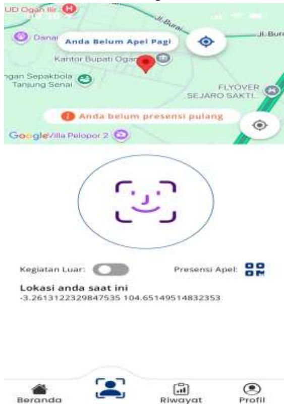
Pada tampilan ini, Sistem Presensi Online SINONA menampilkan halaman utama presensi yang terintegrasi dengan teknologi Global Positioning System (GPS) dan face recognition. Peta digital digunakan untuk menunjukkan posisi geografis pegawai secara real-time pada saat melakukan presensi. Sistem secara otomatis membaca lokasi pengguna dan menampilkannya dalam bentuk titik koordinat serta penanda lokasi pada peta.
