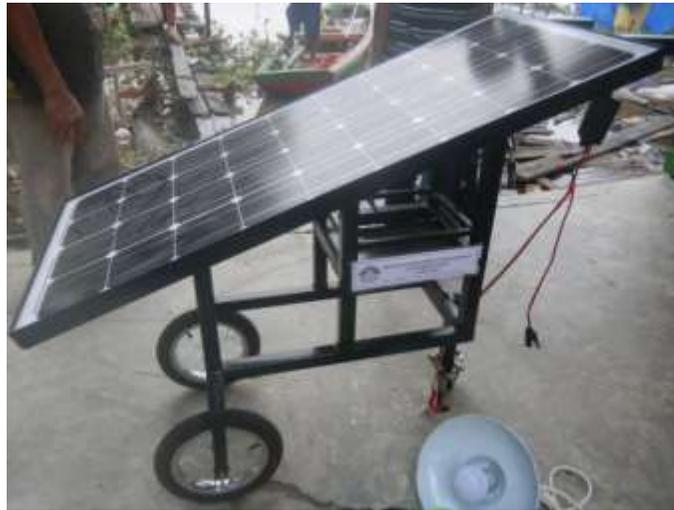
**Gambar 4.** Konstruksi mekanikal MSBC yang dibuat.
