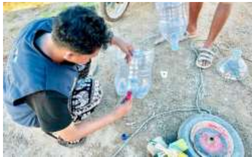
Gambar 6. Pembuatan Lubang Dan Pemasangan Keran Pada Komposter
