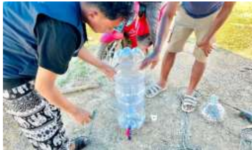
Gambar 7. Penyusunan Bagian Atas Dan Bawah Komposter
