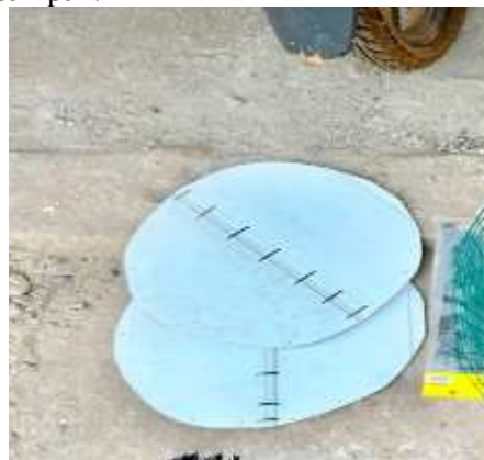
Gambar 12. Penyiapan Infraboard Berbentuk Lingkaran untuk Bagian Atas dan Dasar Wadah
