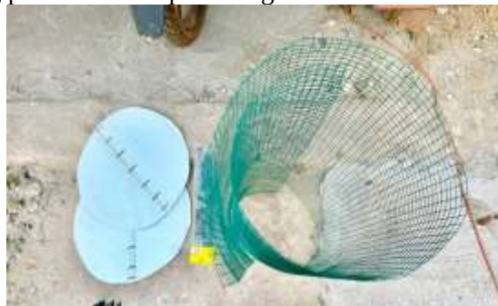
Gambar 9. Persiapan Bahan Jaring Besi Dan Infraboard Untuk Pembuatan Tempat Sampah Anorganik
