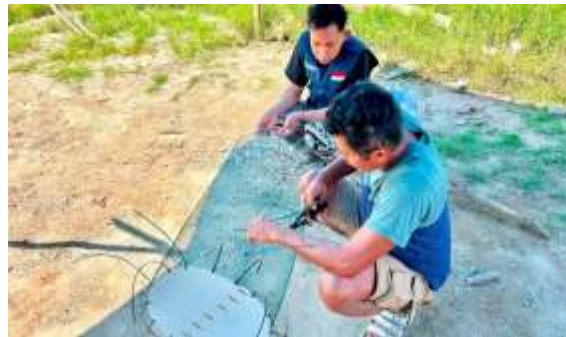
Gambar 10. Penyesuaian Ukuran Jaring Besi Sebelum Dibentuk Menjadi Rangka Tempat Sampah
