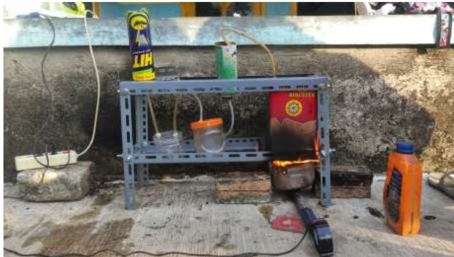
Gambar 1 Alat Pirolisis Bahan Bakar Oli Bekas
