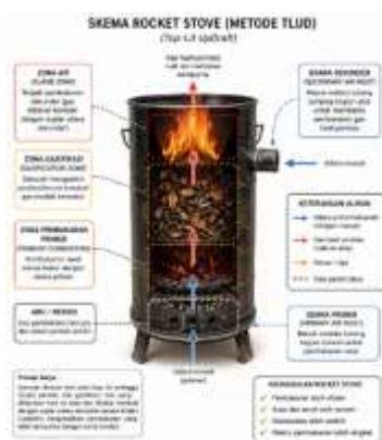
Gambar 2. Skema Rocket Stove Metode TLUD
