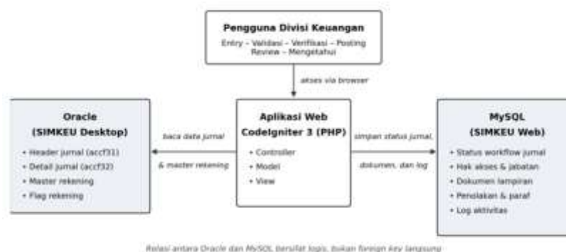
Gambar 2. Skema penggunaan basis data Oracle dan MySQL pada sistem usulan
