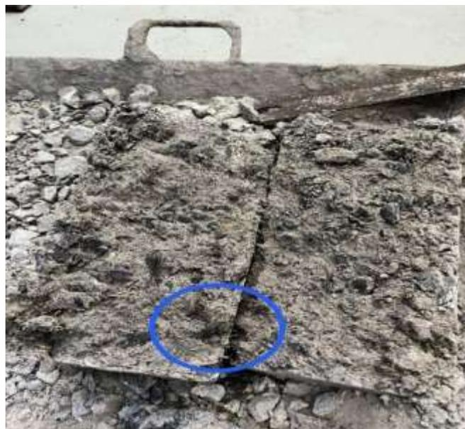
**Gambar 1** Balling Effect pada beton variasi 3 cm
